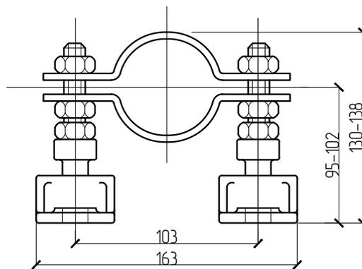
Опора предназначена для крепежа средних и тяжелых трубопроводов.
