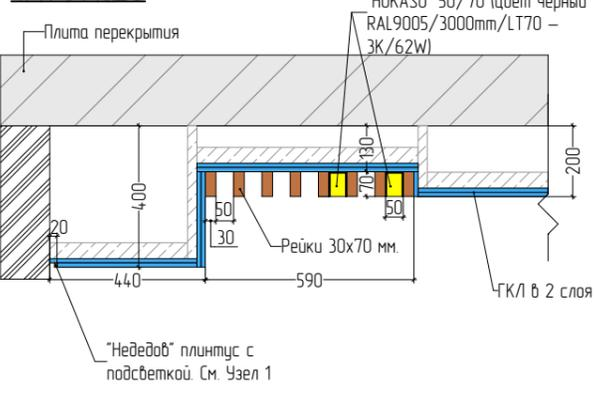
Принципиальная схема "Недедов" плинтус с подсветкой. Узел Стена - Потолок ГКЛ (2х слойный). М 1:5
