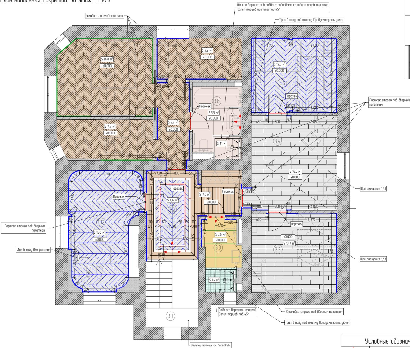
Порожек - пробковый компенсатор, шлифованный, в цвет доски. (Точную высоту/забариты уточнить после выбора напольных покрытий). Кол-во 4,8 м.
