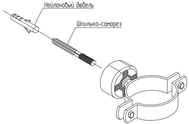
Крепление к строительной конструкции
