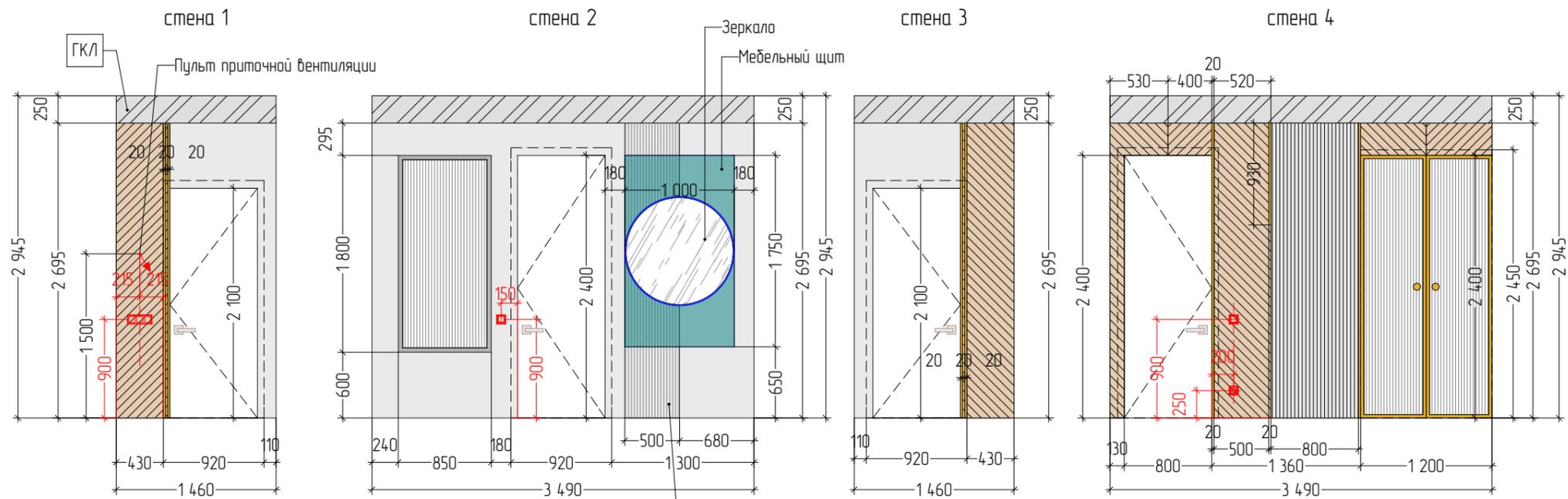
Оштукатурить стену с использованием П-образных профилей сечением 10x10 мм
