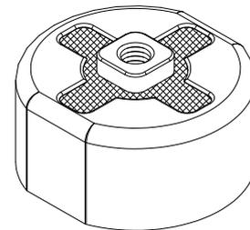
Опора предназначена для крепежа легких трубопроводов из полимерных труб
