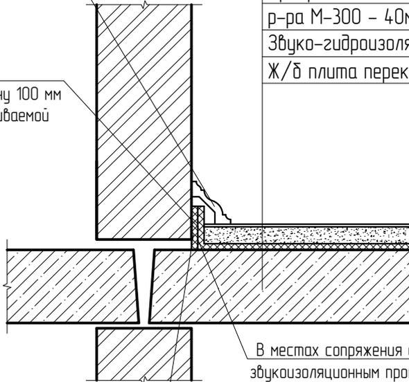
В местах сопряжения стяжек, выполненных по звукоизоляционным прокладкам или засыпкам, с другими конструкциями (стенами, перегородками, трубопроводами, проходящими через перекрытия, и т.п.) должны быть предусмотрены зазоры шириной 25-30 мм на всю толщину стяжки, заполняемые звукоизоляционным материалом в соответствии с п. 8.2. СП 29.13330.2011 Полы.
